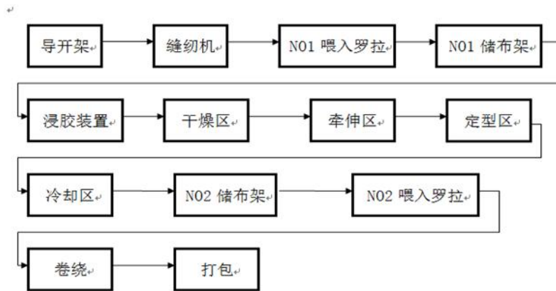
图 4-5 浸胶工艺流程图
